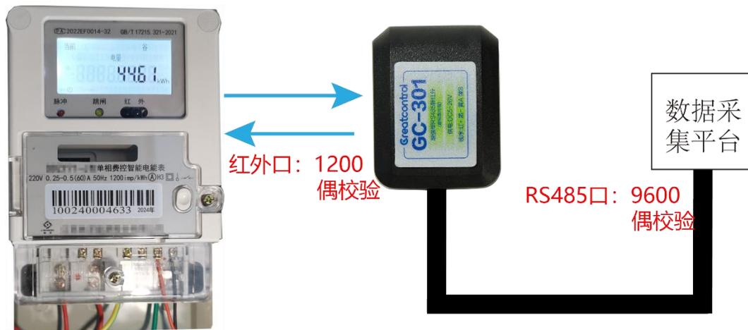
**步骤六：**（如上图）参数修改好后，数据采集平台可以用 9600 波特率读取电表数据。
