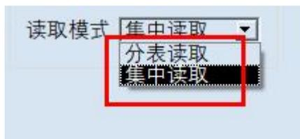
如上图模块支持两种 Modbus 协议读取模式，“分表读取”和“集中读取”。
