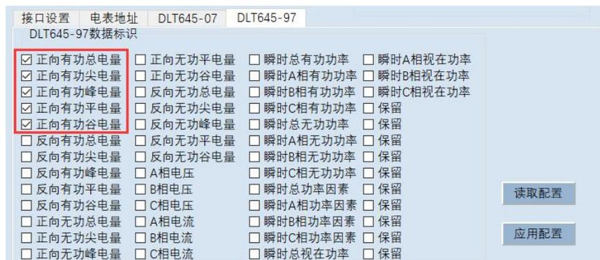
下图为上位机读取到的项目：**DLT645-2007** 协议的电表采集 7 个项目，共 14 个寄存器；**DLT645-1997** 协议的电表采集 5 个项目，共 10 个寄存器。
