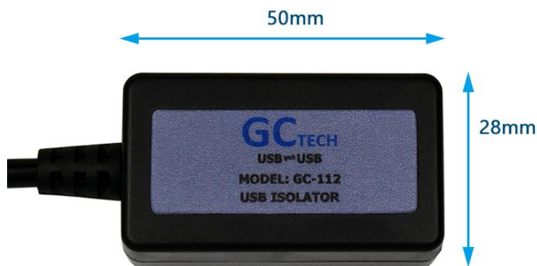
如图 模块长宽高尺寸: 50*28*20 mm
